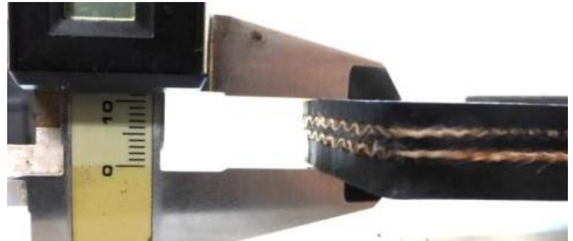
Contrôle d'épaisseur membrane Bando Chemicals (Japan) © J Aubonnet - BRLi
